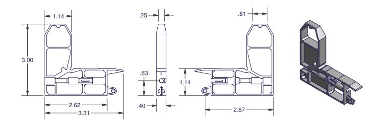
ALSO USED WITH 4876 ROLLER AS A CORNER / ROLLER ASSEMBLY.
