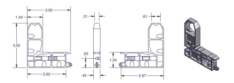
ALSO USED WITH 4876 ROLLER AS A CORNER / ROLLER ASSEMBLY.
